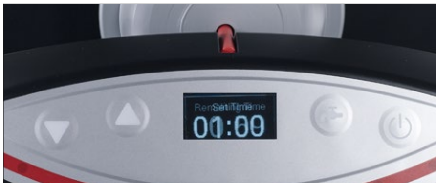
Über die Buttons steuern wir die Knosti. Das Display zeigt dabei die restliche Reinigungszeit an. Der Standard ist eine Minute. Es lässt sich aber auch mehr Zeit einstellen
