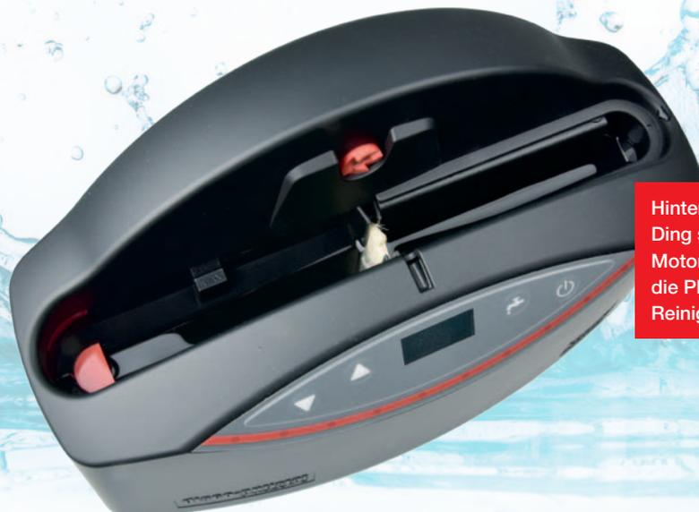
Hinter dem roten Ding sitzt der Motor, er dreht die Platte im Reinigungsbad.
